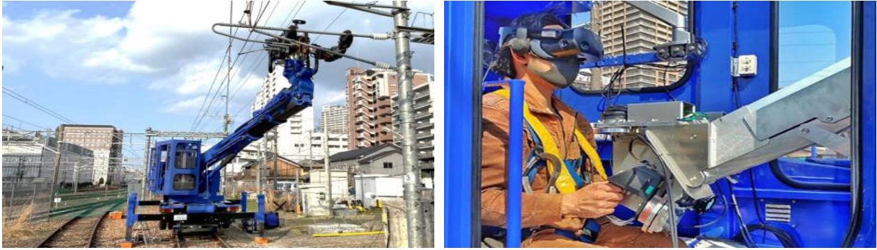
[그림 1-12] 일본 맨-머신 시너지 이펙터스의 ‘다기능 철도 중장비’의 프로토타입(좌), VR을 활용한 조종 모습(우)(사진 출처: JR서일본)
