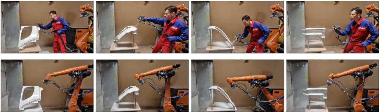
[그림 2-14] 실환경 기반 작업 시연을 통한 학습용 대용량 데이터셋 구축 예시 1: (위) 자동차 부품 도장 시연 과정, (아래) 시연 학습을 통한 로봇 작업 수행. 작업자 시연 시 외부 센싱 시스템이 완벽히 구축되어 있는 환경에서만 시연이 가능하며, 시연된 경로만 단순 재현이 가능하다는 한계가 있음(출처: 리투아니아 Industrial robotics사).
