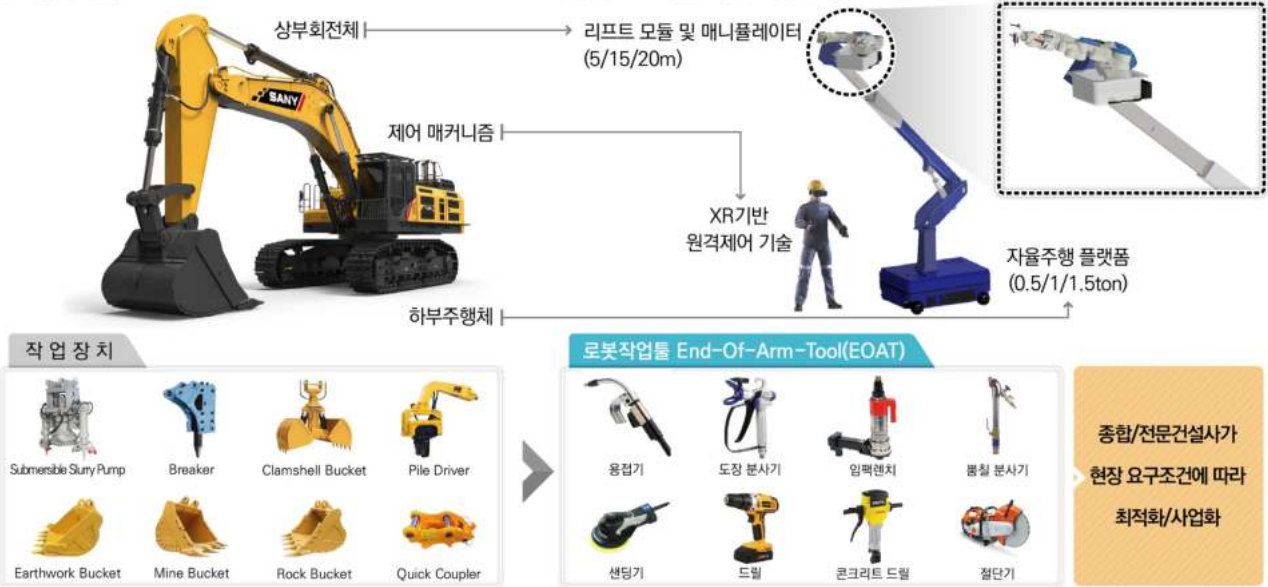
[그림 2-5] 주요 개발 방향 2 : 건설로봇 원격제어 기술
