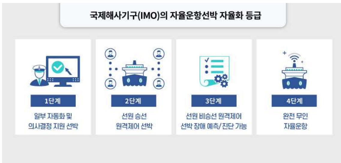
[그림 V-1] 국제해사기구(IMO)의 자율운항선박 자율화 등급
