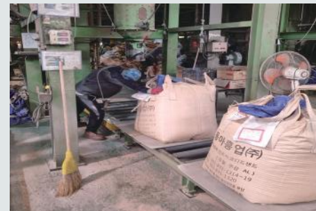
모래 투입 후 호이스트 및 지게차 이송을 위한 수작업 컨베이어 이송작업
