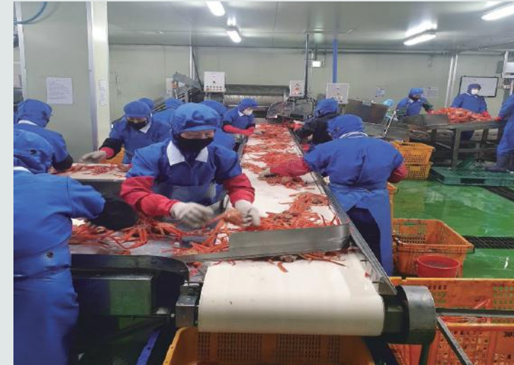
원물의 다양한 크기와 불량상태 확인 및 탈갑과 절단을 위한 다수의 인력 기반 흐름 생산 진행
