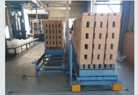
적재 공정 소성가공을 위해 소성대차에 규칙적으로 제품을 쌓아야 하고 열처리 효율과 불량감소를 위해 균일한 소성대차 적재를 필요로 하는 공정
