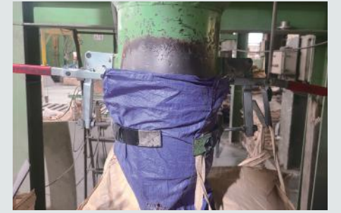
모래 투입을 위한 포대의 호퍼 입구와 체결을 위한 체결과 고정 장치
