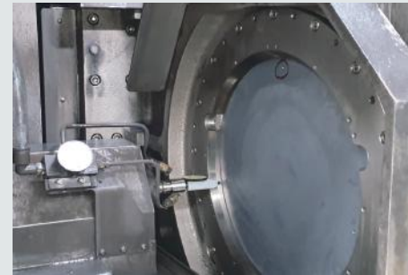
위치 센서 등을 활용해 틀어진 위치 및 방향 편차 측정
