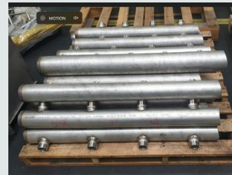
[부품 정렬 및 용접] 가지 배관 제작의 단순, 반복 작업
