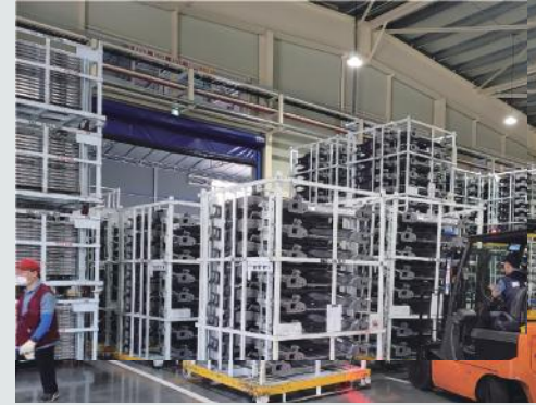
완적 PLT 취출 및 이송을 위한 유인 지게차 운용으로 인적 자원 투입 과다
