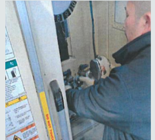
작업자의 가공품 수동 투입으로 인한 작업자 피로도 가중, 휴먼에러 발생 및 생산성 저하
