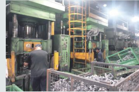
트리밍 장비에 제품을 작업자가 수동으로 장착 및 배출 (작업안전, 시간당 생산성 및 품질 저하)
