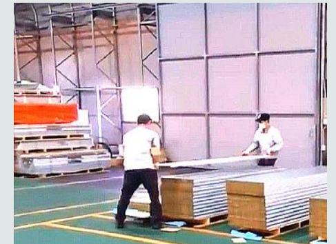
2인 1조의 길고 무거운 판넬 이송 작업은 어렵고 힘든 작업
