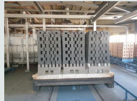
소성용 대차에서 제품을 하차하는 공정 소성 공정이후 블랙브릭 제품을 포장기로 이송하고 정렬하는 단순 반복적인 중량물 이송 작업으로 작업자가 기피하는 공정
