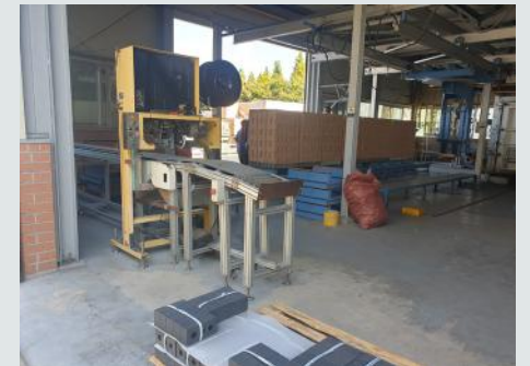
포장 및 팔레트 적재 공정 제조된 블랙브릭을 출하하기 위해 밴딩하고 팔레트에 적재하는 공정으로 출고후 불량발생을 최소화 하기 위한 공정관리를 필요로 한다.
