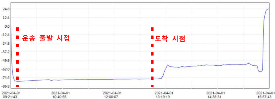
<그림 38. 인체자원 운송 시 온도 모니터링>
