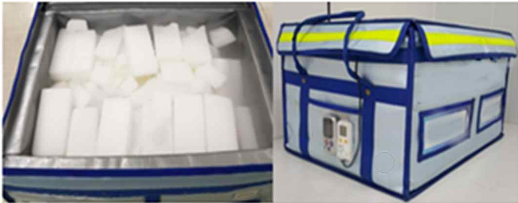
<그림 37. 인체유래물 운송용 전용상자 및 드라이아이스 적재>
