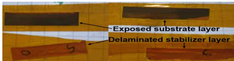
[그림 3] 선재 박리 테스트 사진(출처: Song, Jungbin et al., IEEE Trans. Appl. Supercond., 34.5, 2024: 6600205.)
