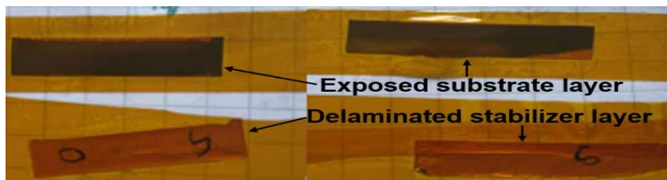
[그림] 선재 박리 테스트 사진 (Courtesy of J. Song (Grenoble))
