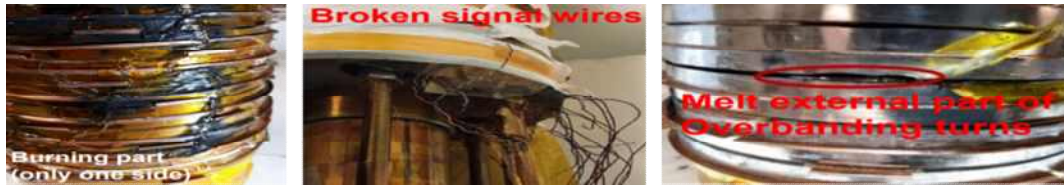
[그림 4] 고자기장 자석의 퀵치 사고 후 발생한 손상 사례
