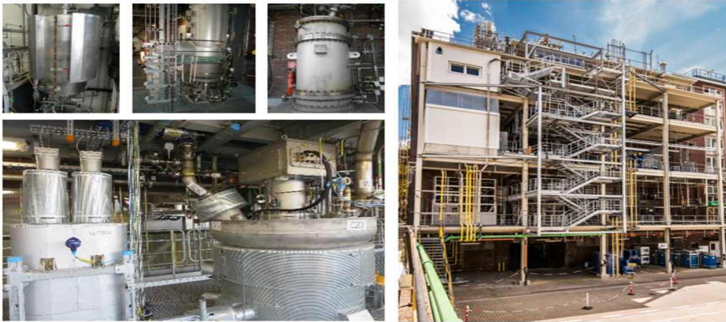
[ BASF의 개념 검증용 반응기(좌)와 건설 중인 Pilot Plant(우) ]
