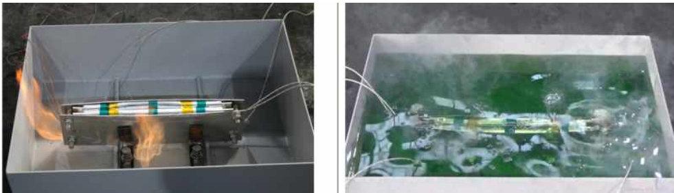
< 외부 열적 요인에 의한 전지 화재발화 순간(좌측:대기중, 우측:액침) >
