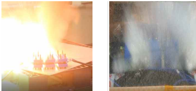
< 전기적 DC(CC) 과충전에 의한 전지 화재발화 순간(좌측:대기중, 우측:액침) >
